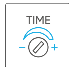
Regulacja czasu świecenia min. 10sek, max. 30min. Adjustable time setting min. 10sec., max. 30min.
